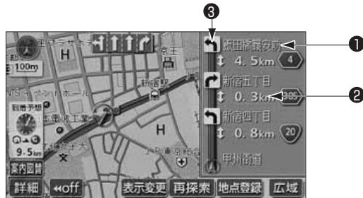
**① 案内ポイント** 分岐する交差点・インターチェンジ (IC)・ジャンクション (JCT) 名称が表示されます。
