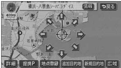
**5** **目的地セット**（**新規目的地**、**追加目的地**）にタッチしたとき、高速道路などの付近では、目的地を設定する道路の種類を選択する画面が表示されることがあります。
