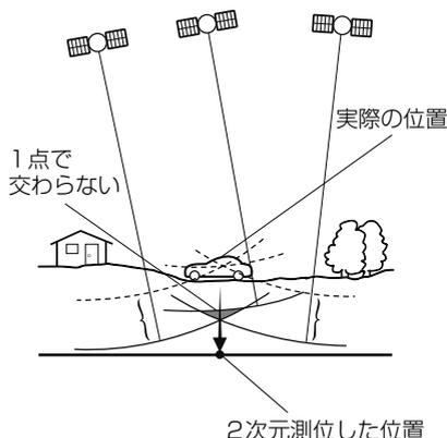
1個の衛星から電波を受信するとその衛星との距離がわかり、3個の衛星から受信すると現在地が測位できます。
