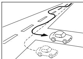
車線変更など蛇行運転をしたとき、現在地がずれて表示される。
