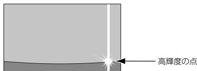
※ スミヤ現象：高輝度の点（車体に反射した太陽等）がカメラに映るとその点の上下（縦方向）に尾を引く現象。
