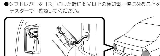
\*リバース信号端子を接続しないと車両を後退させた際に自車位置のズレが発生する恐れがあります。
