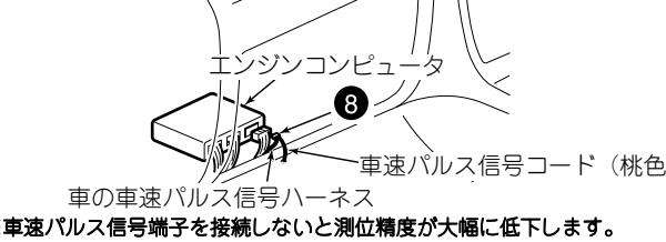
\*車速パルス信号端子を接続しないと測位精度が大幅に低下します。
