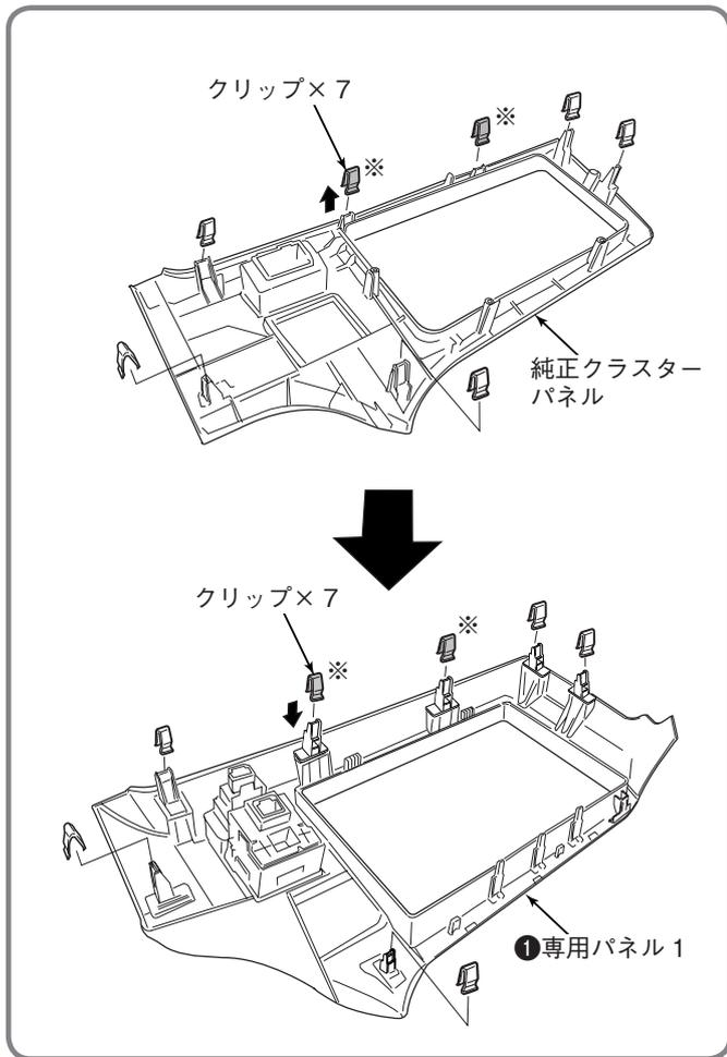
2. 純正クラスターパネルにあるクリップを取り外し、専用パネル1に取り付ける。
