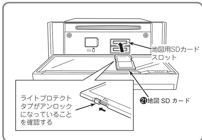
5. 地図SDカードを「地図」と記載あるスロットに挿入する。
