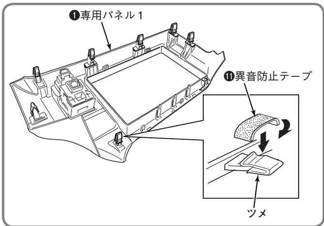
10. 専用パネル1を車両に取り付けた際、ツメ部分がガタつく場合があります。その場合は異音防止テープをツメ部分に巻いて取り付けてください。
