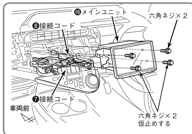
7. メインユニットに接続コード、ラジオアンテナ、GPS・TVアンテナコードオプション5Pコード接続する。
