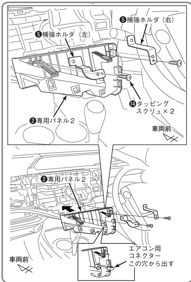
2. 専用パネル2を車両側に取り付ける。
