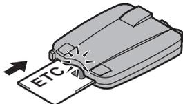
ETCユニットにETCカードを入れて、緑色ランプが点灯していることを確認します。橙色ランプが点灯している場合は、「異常発生時のランプ表示とブザー音/音声案内 (21ページ)」を参照してください。
