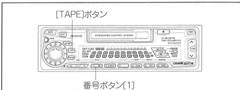
ここで操作は、[TAPE]ボタンを押してカセットモードに切り換えてから行ってください。ここでは、すでにカセットを装着していることを前提に説明します。
