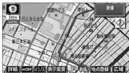
●道路形状警告表示
