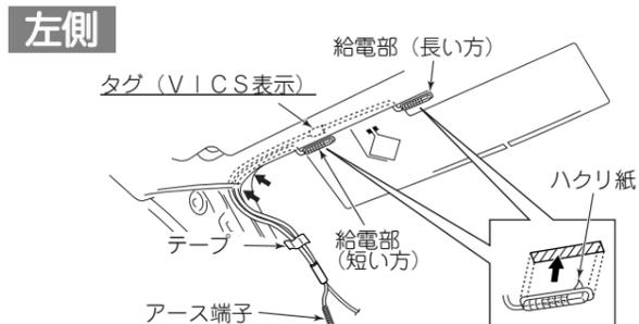
フィルムアンテナの車両内側の端子ベースにTVアンテナコード（右）の給電部を合わせてください。
