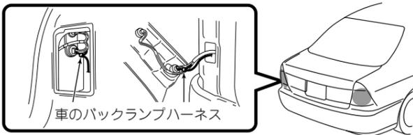
※リバーシ信号端子を接続しないと車両を後退させた際に自車位置のズレが発生する恐れがあります。
