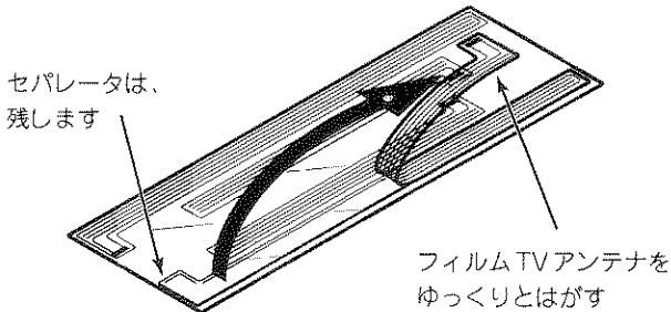
15 フィルムTVアンテナの、のり面に中性洗剤を1~2滴を加えた水を均一にスプレーします。
