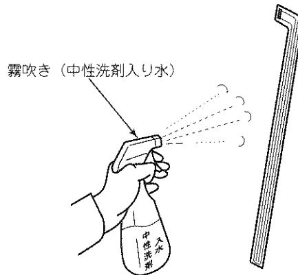
16 フィルムTVアンテナをマーキングに合わせてフロントガラス内側面に貼り付ける。
