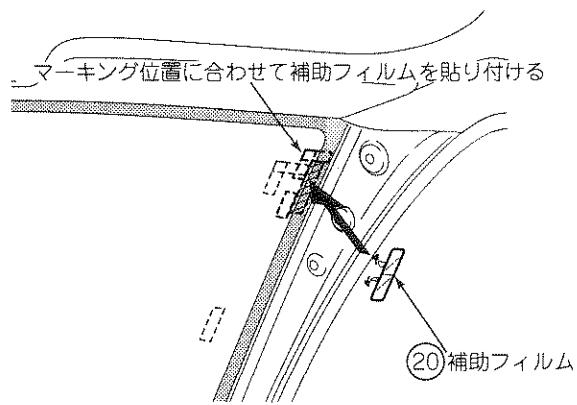
9 シワが付かないように注意して補助フィルムとガラス面との間にに入った水、気泡を付属のヘラを使用して押し出す。
