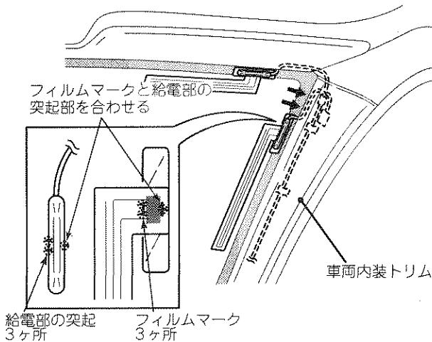
28 アンテナコードをハーネス固定テープで固定しながらアンテナブースター取付位置まで配線する。
