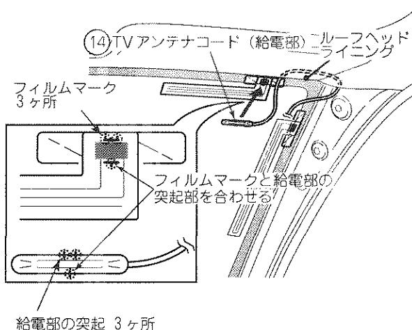
21 TVアンテナコード（横貼付け側）をルーフヘッドライニング（天井）の中に押し込む。
