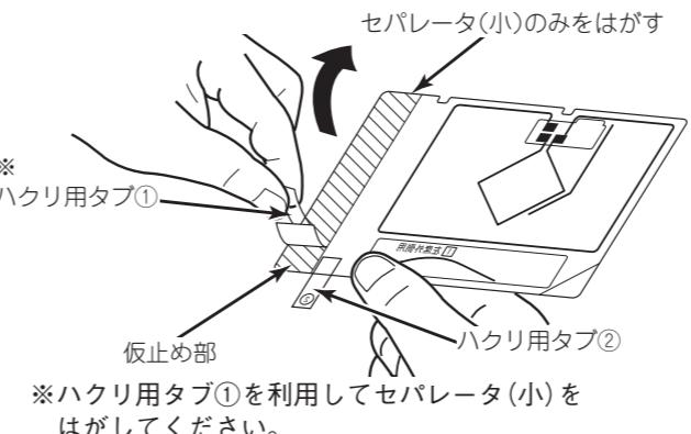
**注意** セパレータ(大)：ハクリ用タブ②側は、はがさないでください。フィルムアンテナの仮止めをする前にセパレータ(大)をはがすとフィルムアンテナを正しく貼ることができません。
