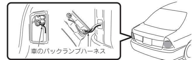
※リバース信号端子を接続しないと車両を後退させた際に自車位置のズレが発生する恐れがあります。
