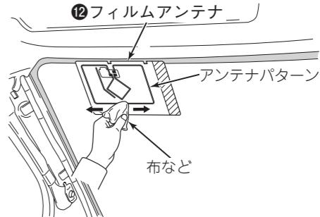
**注意** アンテナパターン部をこする際は、ヘラなど固いものを使用しないでください。フィルムアンテナの傷つきや破損の原因になります。
