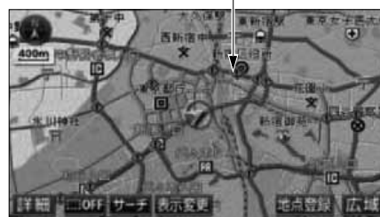
交通事故多発区間警告マーク
