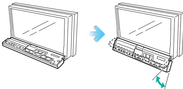
3 調整後、**TILT・EJECT** を押します。
