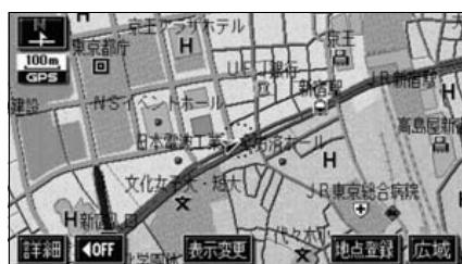
3個以上のGPS衛星からの電波を受信して、自車の現在地を測定することです。本機では、現在地画面の左上隅に表示する「GPS」マークの色により衛星の状況を表示しています。
