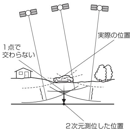
GPSは3点測量の原理にしたがって位置を計算しています。
