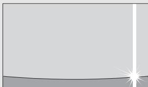
※スミヤ現象：高輝度の点（車体に反射した太陽等）がカメラに映るとその点の上下（縦方向）に尾を引く現象。
