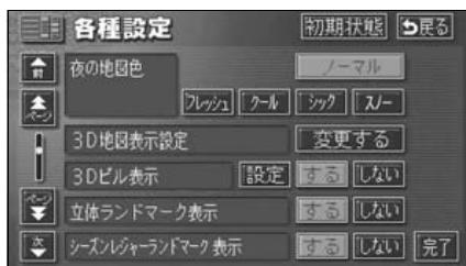
**3** 表示する高さ(階数)を上げるときは▶、下げるときは◀にタッチして高さを設定します。
