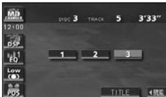
「優先画面の設定」(36 ページ)で画面の切り替えを自動解除に設定すると、操作画面を表示させてから約20 秒以上(TV・DVD 操作画面では約6 秒以上)操作をしなかったときは、操作画面は自動解除されオンスクリーン表示に切り替わり、その後もとの画面にもどります。また、画面の切り替えを継続表示に設定すると、操作画面は自動解除されずに継続して表示されます。
