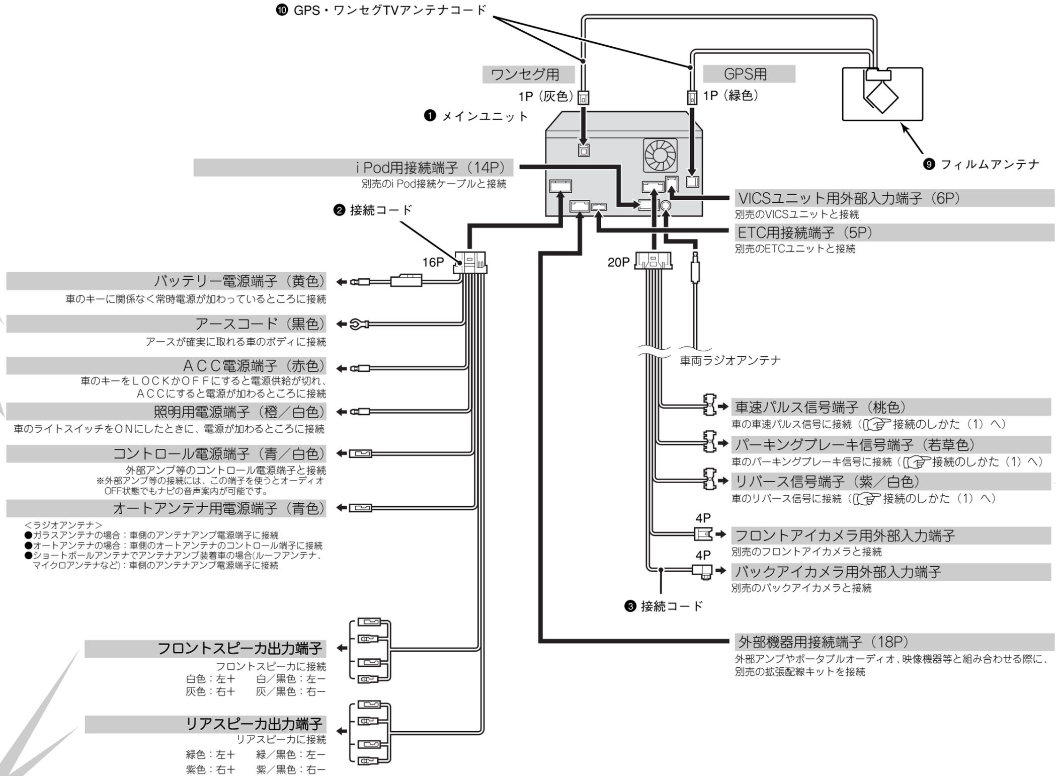
車速パルスは必ず接続してください。接続しないと測位精度が大幅に低下します。
