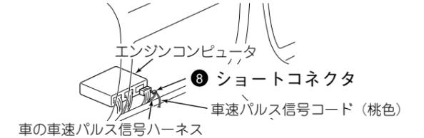
※車速パルス信号端子を接続しないと測位精度が大幅に低下します。
