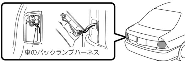
※リバース信号端子を接続しないと車両を後退させた際に自車位置のズレが発生する恐れがあります。
