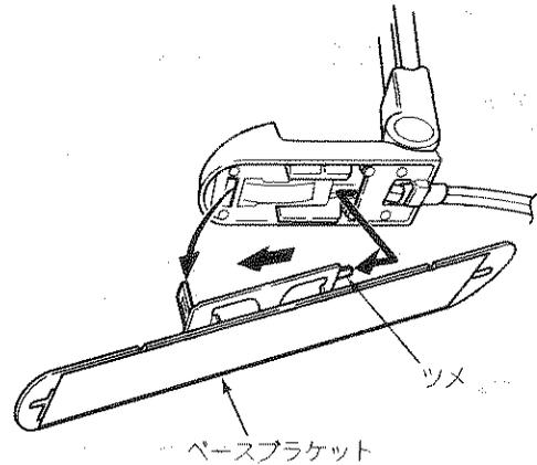
**4** 車側に取り付ける前にベースブラケットをボディ形状に合わせて曲げる。
