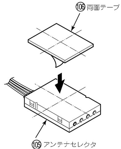
**14** アンテナセレクタの出力コードがメインユニットへ届く範囲内にアンテナセレクタ取付位置（助手席足元カーペット下等）を決める。
