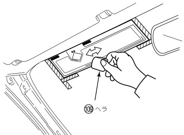
**13** アンテナセレクタに両面テープを貼り付ける。
