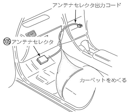
**15** アンテナセレクタを助手席足元のカーペット下のフロア部分に固定する。
