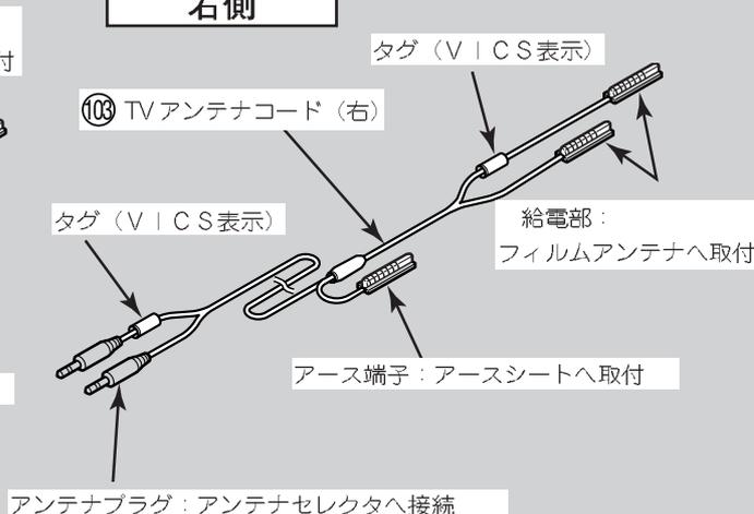
1 作業中のTVアンテナコードにかかる負担を軽減させるため、TVアンテナコードをテープでガラス面に仮固定する。
