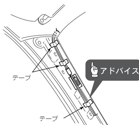
6 TVアンテナコードをテープで固定しながらアンテナセレクト取付位置まで配線する。
