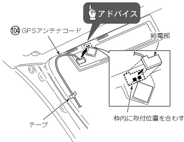
3 ルーフヘッドライニングの端の部分を少し下げGPSアンテナコードをルーフヘッドライニング内に収め配線する。
