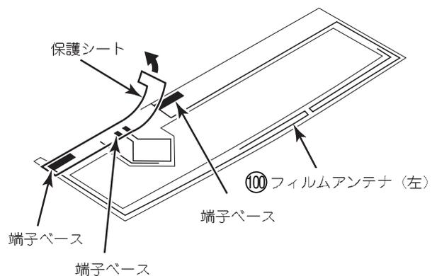
8 フィルムアンテナのセパレータハクリ部からセパレータをはがす。
