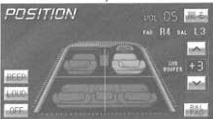
TVモードのときは、操作モードから[設定]をタッチすると音質調整のタッチスイッチが表示されます。
