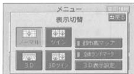
**ワンポイント** 再度、2画面表示にさせたときは、前回、2画面表示にさせていたときの縮尺で地図が表示されます。
