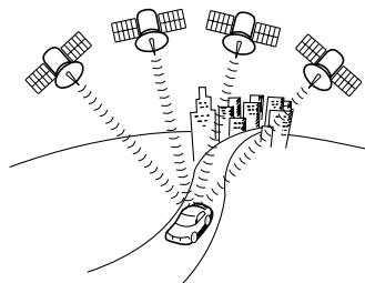
GPSは、高度約21000kmの軌道上を周回するGPS衛星から地上に放射される電波を受信して、現在の位置（緯度、経度、高度）を知ることができるシステムです。この衛星は、主として軍事利用のために米国国防総省によって打ち上げられ管理されていますが、民間の使用も解放されています。
