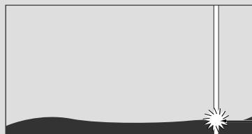
\*スミヤ現象：高輝度の点(車体に反射した太陽など)がカメラに映るとその点の上下(縦方向)に尾を引く現象。
