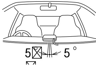
④ VICS のアンテナの取り付け方向は、 $\pm 5^{\circ}$  でセットしてください。これがずれると、うまく受信できないことがあります。
