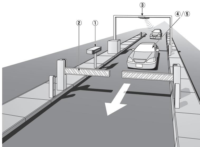
**①路側表示器** 料金所の ETC 車線に設置されています。進入車両に対し、適切に通行の可否などのメッセージが表示されます。
