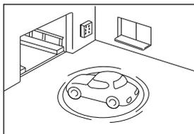
駐車場のターンテーブルなどで、ACC OFFの状態ですり回転したとき、現在方位がずれて表示される。
