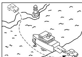
フェリーなど、自転車走行以外で移動したとき、GPSによる測位ができるまで移動前の場所に現在地が表示される。
