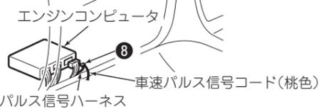
※車速パルス信号端子を接続しないと測位精度が大幅に低下します。
