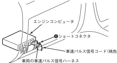
※車速パルス信号を接続しないと測定精度が大幅に低下します。
