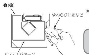
⑩ ⑨、⑩ フィルムアンテナのアンテナパターン部を布などでこすってガラス面に定着させる。
