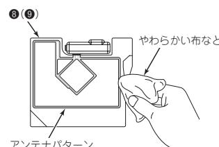
⑩ ⑥(⑨) フィルムアンテナのアンテナパターン部を布などでこすってガラス面に定着させる。
