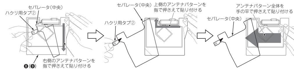
⑧ 粘着面(右上)を押さえながら⑥(⑨) フィルムアンテナからハクリ用タブ②を使いセパレータ(中央)を少しあげます。
