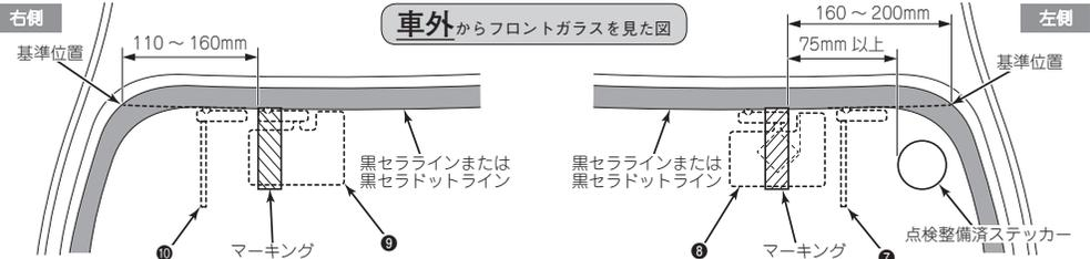
① 上図の寸法に従い、アンテナの貼付位置2箇所を車両外側からテープ等でマーキングする。
