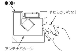
⑩ 8(9) フィルムアンテナのアンテナパターン部を布などでこすってガラス面に定着させる。
