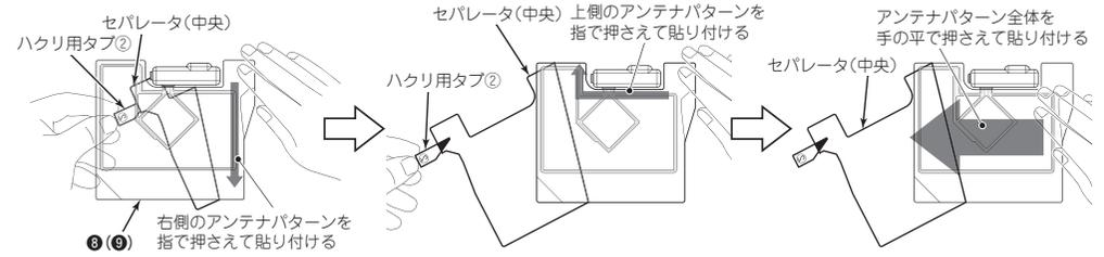
⑧ 粘着面(右上)を押さえながら8(9) フィルムアンテナからハクリ用タブ②を使いセパレータ(中央)を少しはがす。
