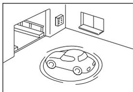
駐車場のターンテーブルなどで、ACC OFFの状態ですり回したとき、現在方位がずれて表示する。
