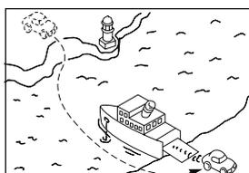
フェリーなど、自車走行以外で移動したとき、GPSによる測位ができるまで移動前の場所に現在地を表示する。
