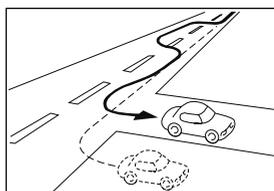
車線変更など蛇行運転をしたとき、現在地がずれて表示する。
