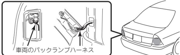
※リバース信号端子を接続しないと車両を後退させた際に自車位置のスレが発生する恐れがあります。
