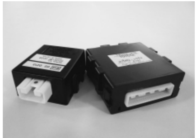
図-1 当社製ゲートウェイECU(左)とトランスレートECU(右) Fig.1 Gateway ECU (left) and Translate ECU (right) of FUJITSU TEN
