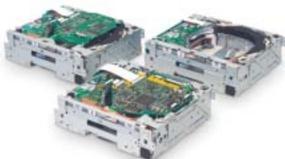
(手前：DVDタイプ，奥左：6枚上基板タイプ，奥右：6枚横基板タイプ)
