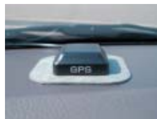
図-2 従来のカーナビ用GPSアンテナ Fig.2 GPS patch antenna for car navigation
