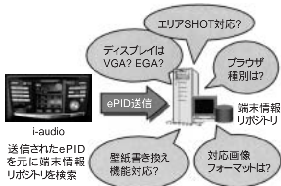
図-5 ePIDによる端末認識 Fig.5 Terminal Recognition
