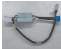
車載用デジタルテレビ アンテナアンブ 従来機種から容積48%削減
