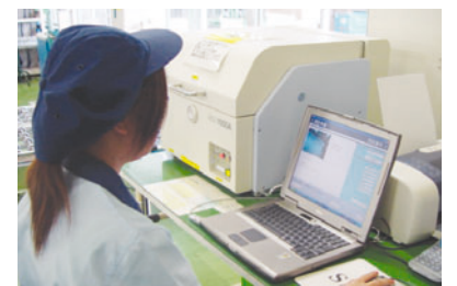
蛍光X線分析装置で有害物質を監視
